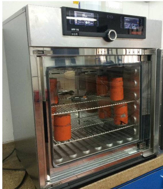
Imagen 8. Colocación de las muestras en camisas de pvc, dentro de la cámara de clima constate.
