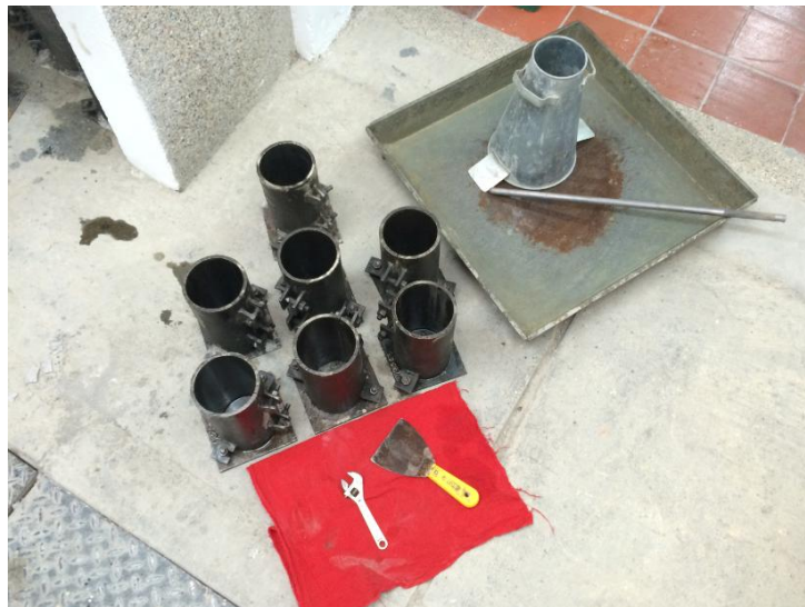
Imagen 2 . Cilindros para prueba al aire libre.
