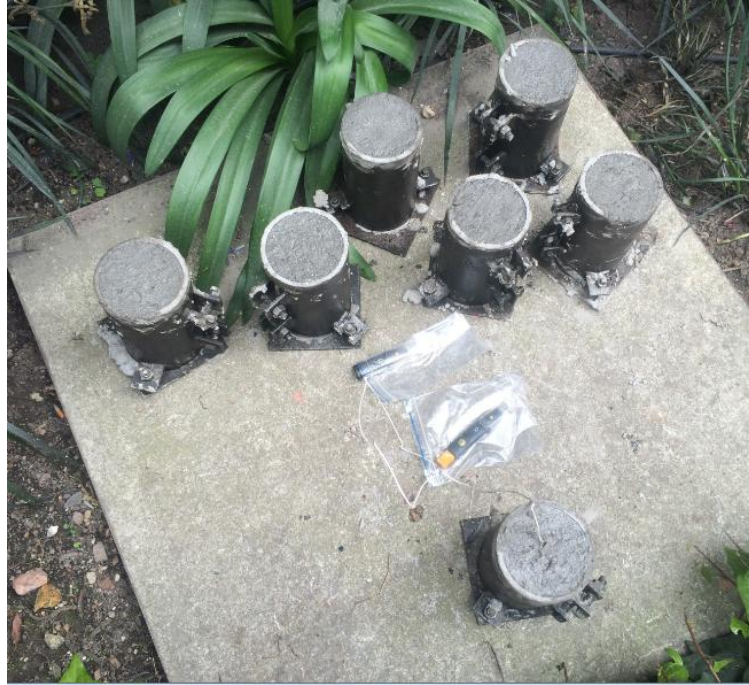
Imagen 7. Fraguado y curado inicial de las muestras dejadas al aire libre
