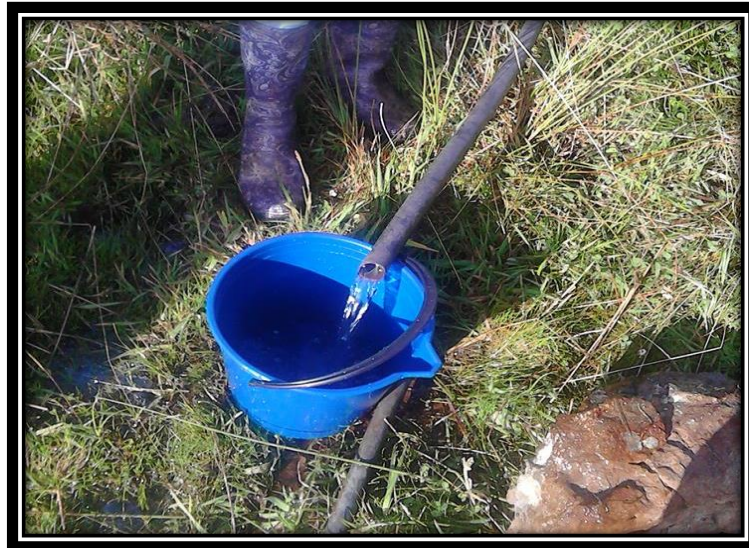
Figura 4 Aforo Caudal Método Volumétrico
