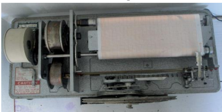
Figura 9. Composición mecánica de un limnógrafo
