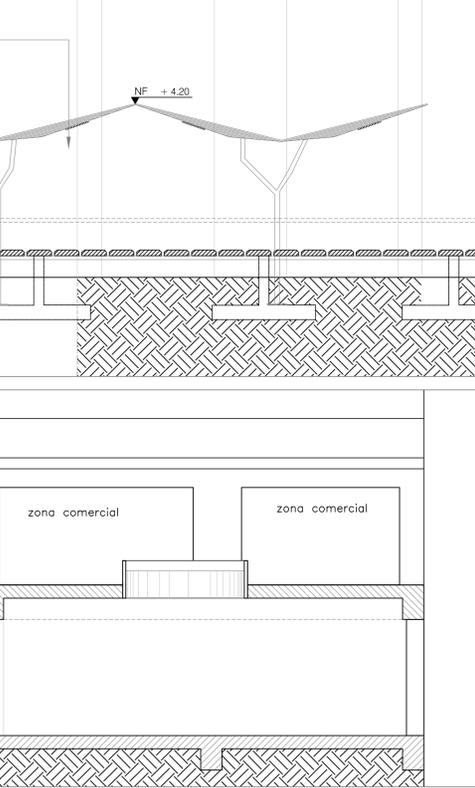
estructura de arbol en aluminio, dotado con paneles solares
