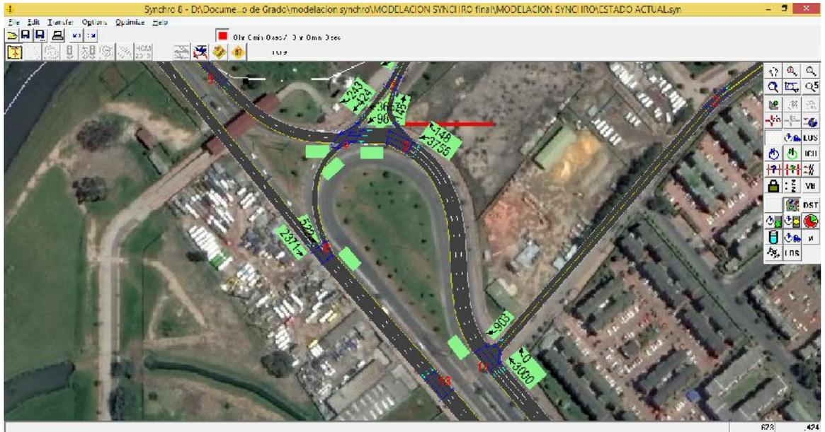
*Ilustración 33 - Simulación condición actual en Synchro. Fuente propia*
