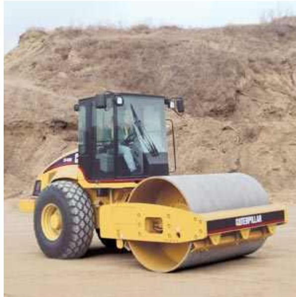
Se encarga de afirmar las capas de la base y sub base granular en la obra y también la carpeta asfáltica.
