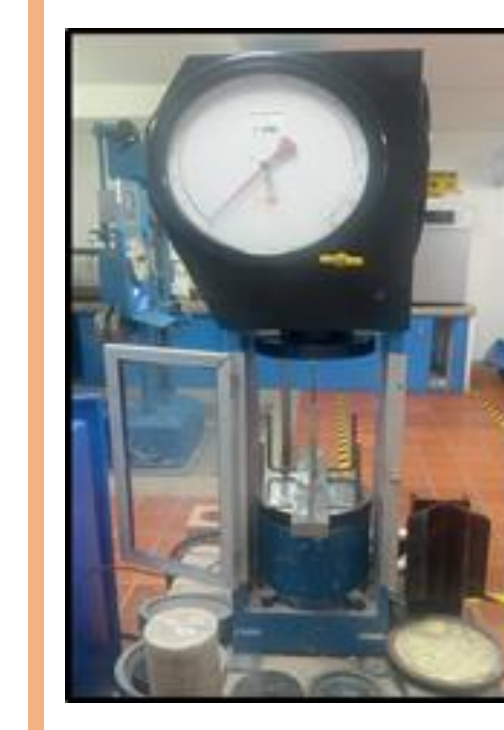
Prensa hidráulica digital para ensayos en concreto.
