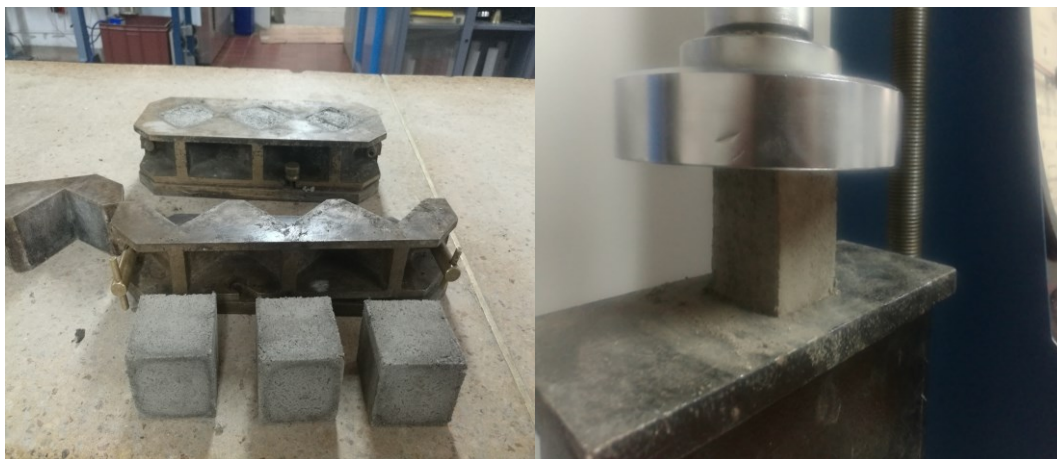
Fotografía 11 Cubos desencofrados y puestos en ensayo
