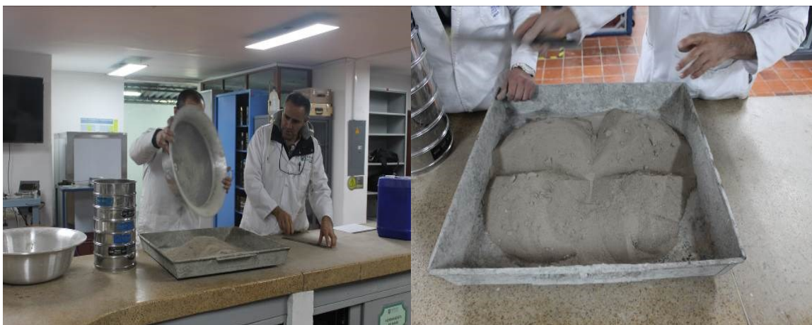
Fotografía 4 Selección y cuarteo del material debidamente pasado por horno durante 24 horas
