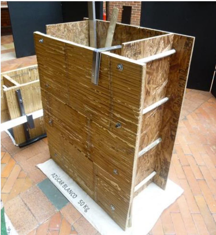
Imagen 35. Encofrado con Lámina de guadua Prensada – Prototipo a Escala 1:1
