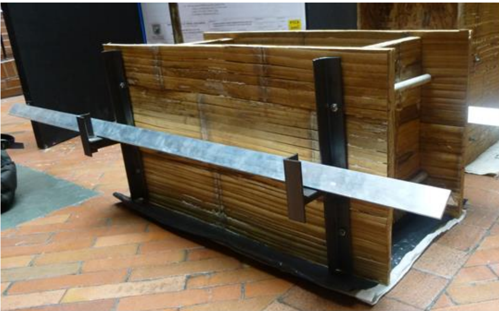
Imagen 34. Encofrado con Lámina de guadua Prensada con alineador y porta-alineador
