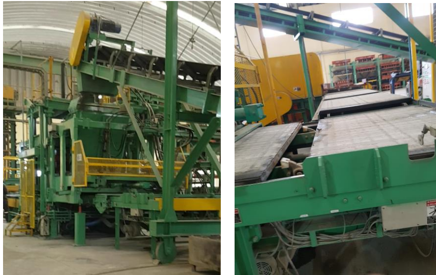
Imagen 42. Máquina de vibro compactación / Imagen 43. Bandas transportadoras con el molde correspondiente
