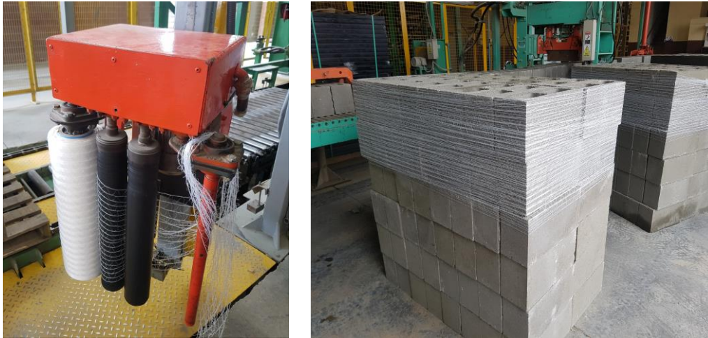
Imagen 49. Máquina de envoltente para el material (malla) / Imagen 50. Apilamiento de bloques de concreto con envoltente de malla
