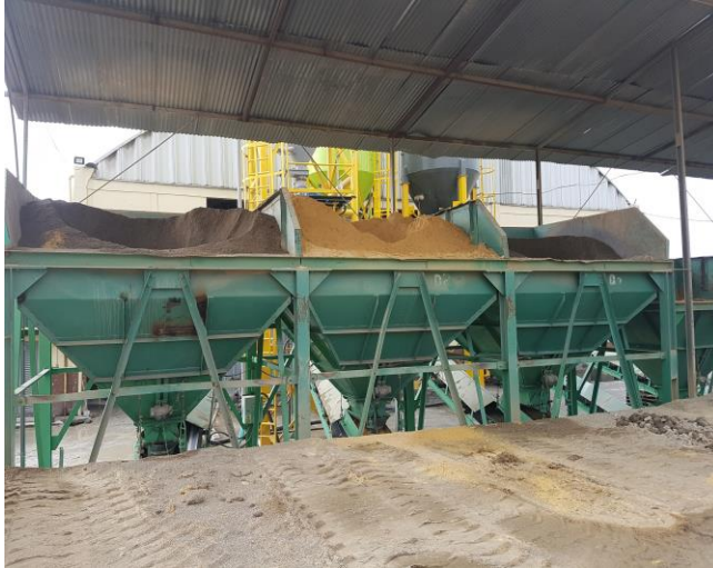
Imagen 38. Tolvas de agregados / Imagen 39. Alimentadores para el mezclado, conectados a las tolvas
