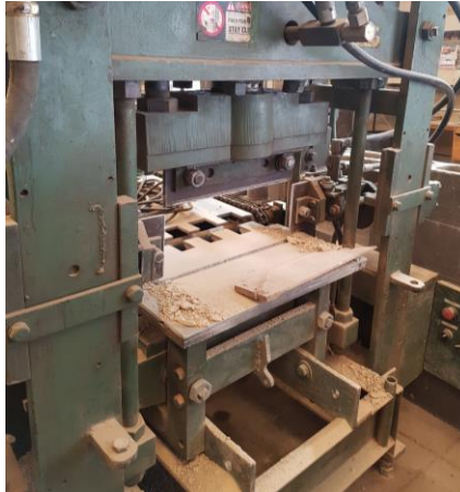
Imagen 28. Máquina cortadora para bloques abujardados
