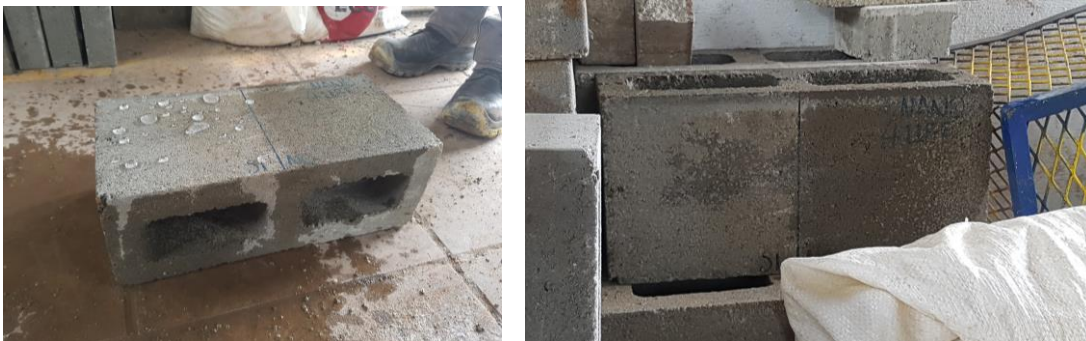
Imagen 55. Prueba al bloque con aplicación del hidrofugante / Imagen 56. Bloque con presencia de hidrofugante y agua
