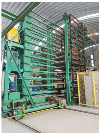
Imagen 46. Stand de transporte para las bandejas con los productos hacia el cuarto de curado
