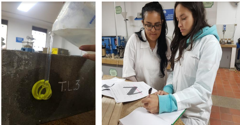
Imagen 128. Ensayo con Pipeta Karsten / Imagen 129. Registro de permeabilidad de bloques de concreto
