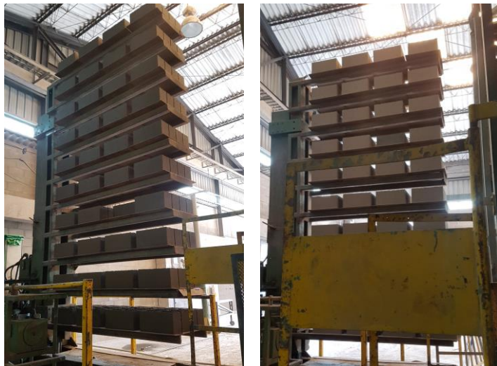
Imagen 21. Máquina transportadora de productos / Imagen 22. Máquina transportadora hacia el curado
