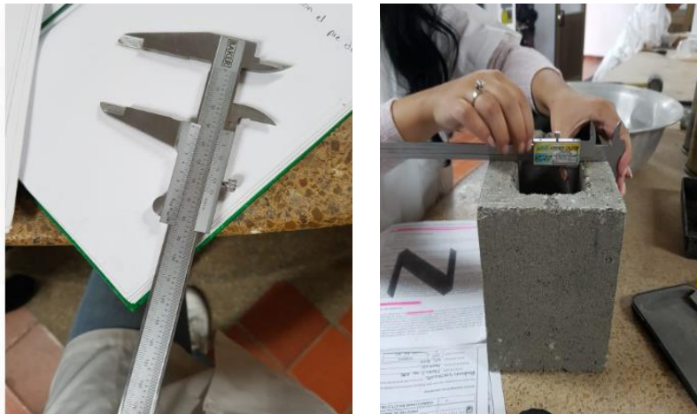
Imagen 122. Pie de rey (calibrador) / Imagen 123. Metro para las tomar las dimensiones del material
