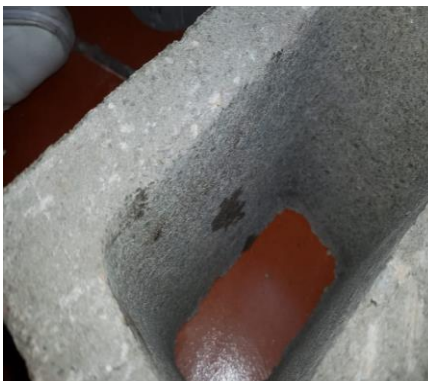
Imagen 132. Ensayo con pipeta Karsten / Imagen 133. Resultado del ensayo con el bloque hidrófugo / Imagen 134. Tabique del bloque en concreto después de utilizarse en el ensayo de permeabilidad
