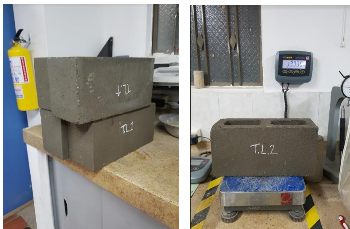
Imagen 126. Bloques saturados, seco superficialmente / Imagen 127. Bloque secado al ambiente
