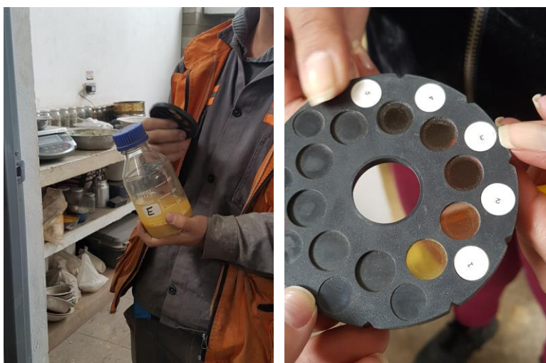
Imagen 33. Ensayo N° 1 frasco con agregado e hidróxido de sodio / Imagen 34. Ensayo N° 2 nivel de materia orgánica en los agregados
