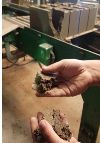
Imagen 25. Inspección de calidad del bloque de concreto
