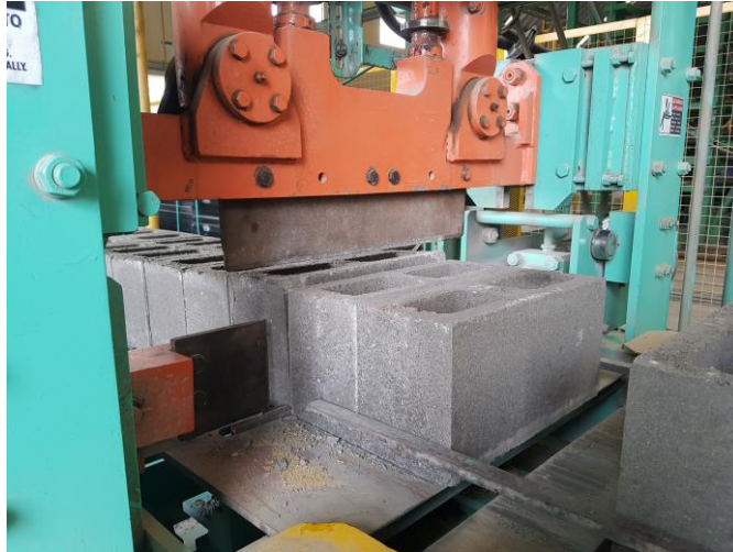
Imagen 52. Máquina para fabricar los bloques abujardados
