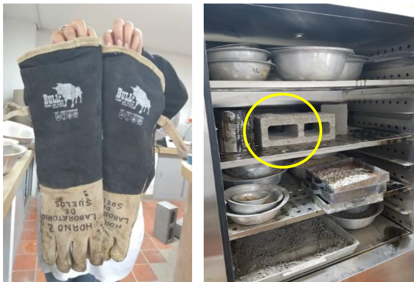
Imagen 124. Guantes para protección de quemaduras / Imagen 125. Horno a una temperatura de 120° para el secado del bloque en concreto
