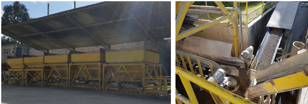
Imagen 9. Tolvas de almacenamiento de materia prima / Imagen 10. Banda transportadora material
