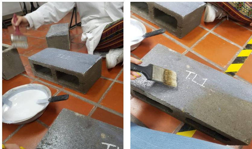
Imagen 130. Hidrofugante pintuco / Imagen 131. Aplicación del hidrofugante a cada espécimen
