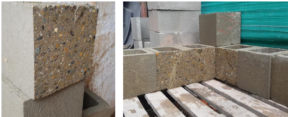
Imagen 71. Acabado al hacer un corte trasversal en el bloque de concreto / Imagen 72. Bloque de concreto con acabado diferente
