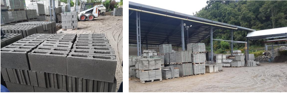
Imagen 64. Almacenamiento de bloques de concreto / Imagen 65. Secado de los bloques en concreto a ambiente
