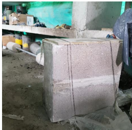
Imagen 75. Piscina para prueba de absorción de los bloques en concreto / Imagen 76. Murete en bloque de concreto para prueba de resistencia
