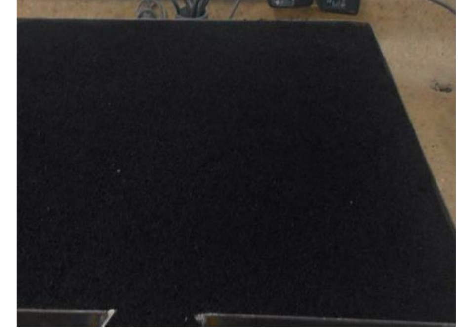
Granulo de caucho esparcido por el molde
