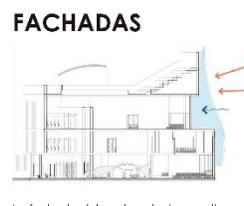
La fachada del equipamiento permite que la radiación del sol no sea directa para un mayor confort térmico dentro del edificio.
