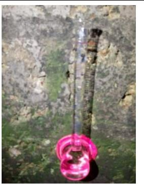
Se inicia con el llenado de la probeta con agua hasta los 5ml y al primer minuto se observa que aún no absorbe nada al igual paso a los 5 minutos, no absorbió.
