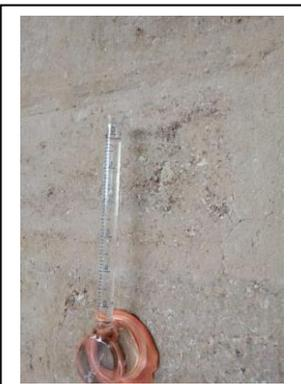
Se inicia con el llenado de la probeta con agua hasta los 5ml y en  $\frac{1}{2}$  minuto absorbió  $\frac{1}{2}$  ml, pasados los 3 min el boque absorbió  $3 \frac{1}{2}$  y pasado los 5mn quedo en 3.6ml
