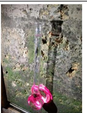
No se llena la probeta ya que en el ensayo anterior no absorbió nada, pasado un minuto se observa que la probeta sigue igual de llena y a los 5 minutos absorbió  $\frac{1}{2}$  ml de agua.
