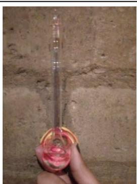
Se inicia con el llenado de la probeta con agua hasta los 5ml , pasa 1 minuto esta no absorbe nada y los 5 minutos se observa que en definitiva no absorbió.
