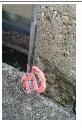
La probeta no se llena ya que en el ensayo anterior no absorbió ni un ml, pasado 1 minuto se observa que esta absorbió ½ ml y a los 5 minutos en total absorbe solo 1ml.
