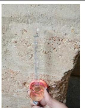
Se inicia con el llenado de la probeta con agua hasta los 5ml y en los primeros 2 minutos el bloque absorbió 2ml en 1 min y a los 4 minutos absorbió por total los 5ml
