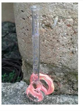
Se inicia con el llenado de la probeta con agua hasta los 5ml , pasado un minuto se observa que la probeta sigue igual de llena y a los 5 minutos no absorbió nada.
