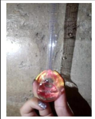
No se llena la probeta ya que en el ensayo anterior no absorbió absolutamente nada, pasa 1 minuto esta no absorbe nada y los 5 minutos se observa que absorbe un 0,1ml
