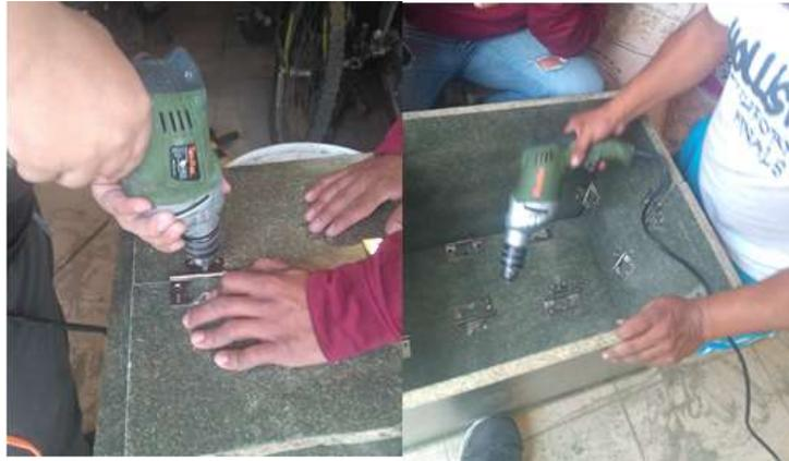
**Figura 17** Instalación de las bisagras Fuente: propia.
