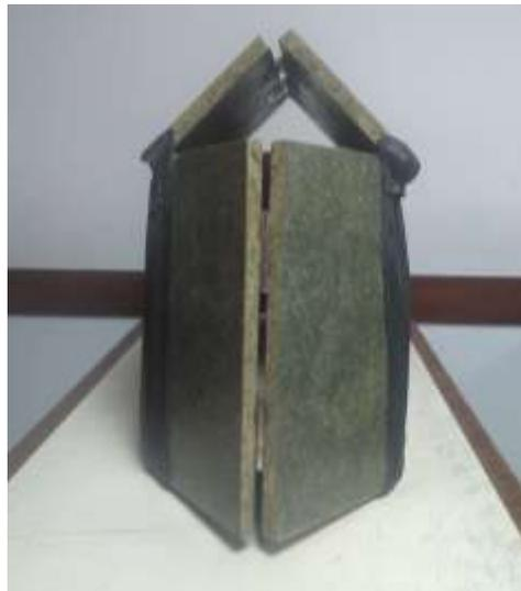
**Figura 20** Casetón plegable en madera aglomerada hidrofugo vista de perfil Fuente: propia.
