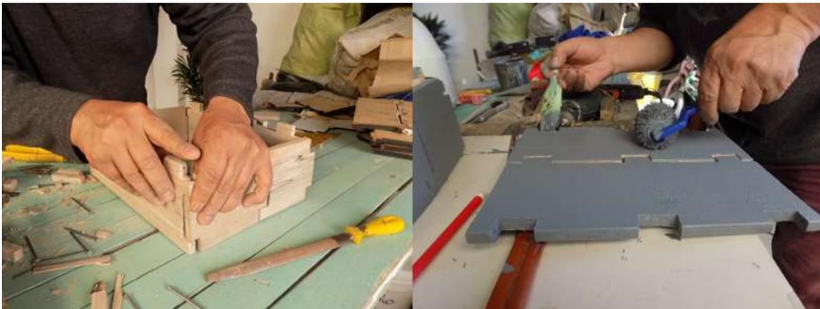
**Figura 28** Ensamble y recubrimiento impermeabilizante de casetón prototipo A1 Fuente: Propia.
