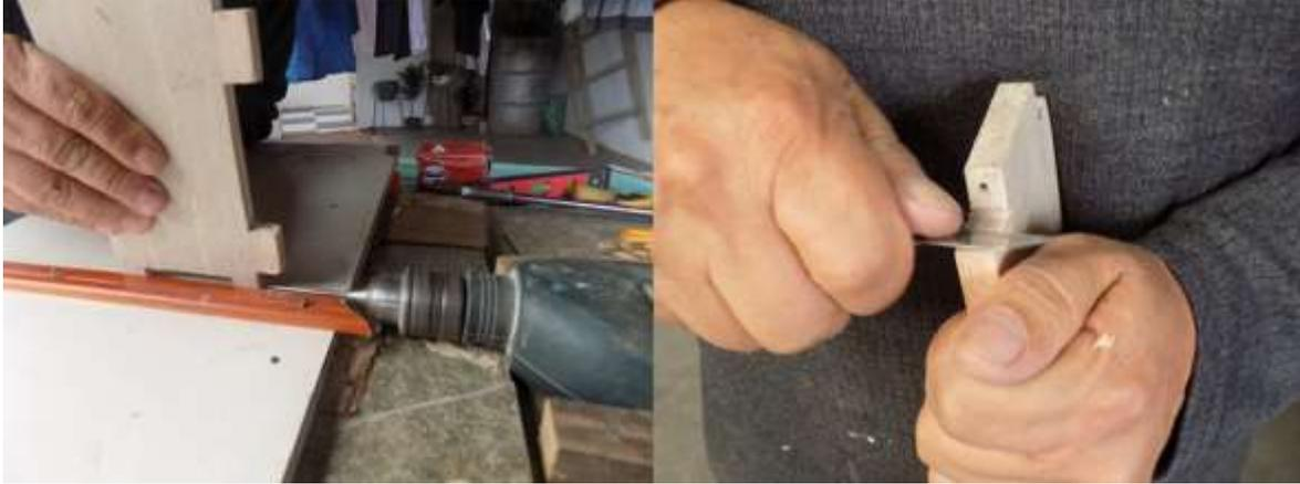
**Figura 27** Perforación de agujeros y cortes finales Fuente: Propia.
