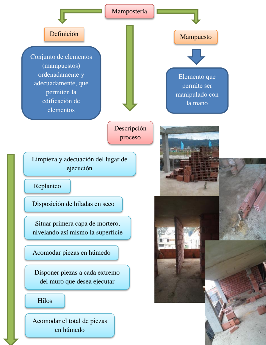
Figura 13. Ejecución de muros con mampuestos cerámicos. Fuente: Autor.
