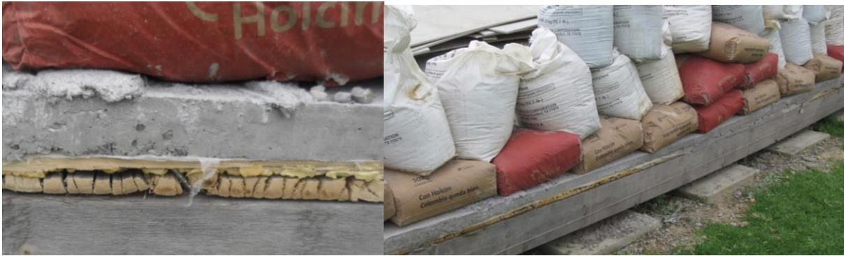
*Figura 22 Falla típica del adhesivo del poliuretano Fuente: Méndez & Riaño, 2017*
