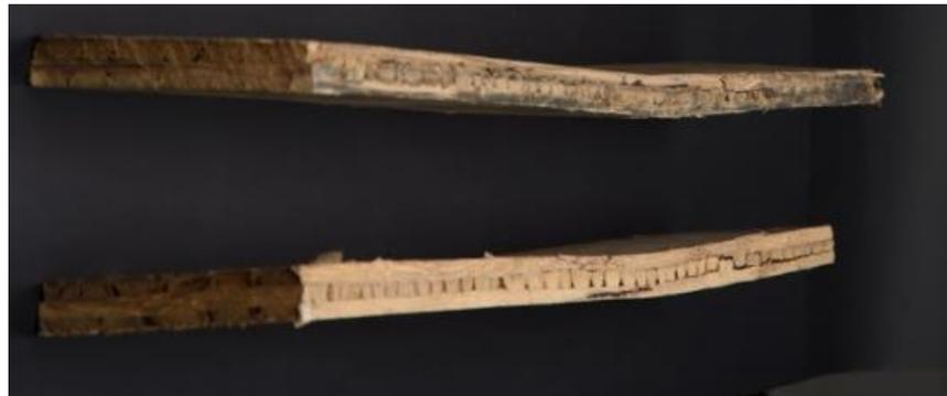
*Figura 24* Probetas ensayadas en Esterilla de guadua contralaminada.
