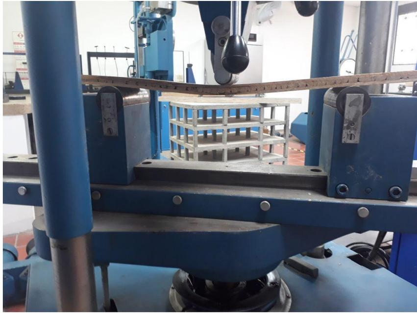
*Figura 25 Ensayo a flexión esterilla contralaminada*
