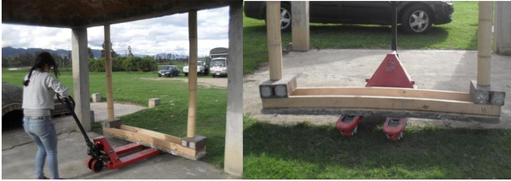
*Figura 23 Flexión en el prefabricado para conocer el tipo de falla. Fuente: Barreto, 2017*
