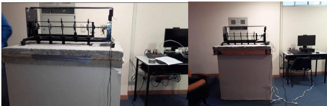
*Figura 16 Ensayo ruido de impacto.*
