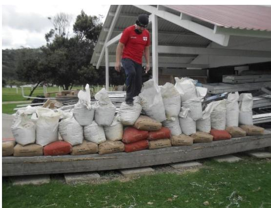
Figura 17 Tablero de 2 capas en esterilla de Guadua. Fuente: Méndez & Riaño, 2017
