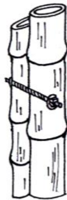
Ilustración 66. Detalle propuesto para la protección del elemento. Fuente: Elaboración propia.
