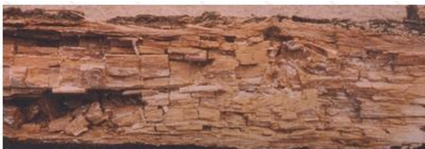
Ilustración 7. Pudrición parda en la madera. Fuente: http://www.biologia.edu.ar/fungi/xilofagos.htm
