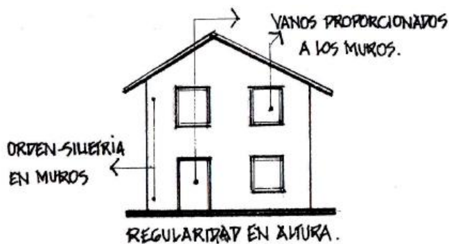
Ilustración 17. Regularidad en altura. Fuente: Vivienda sismo resistente en guadua de Iván Erazo.
