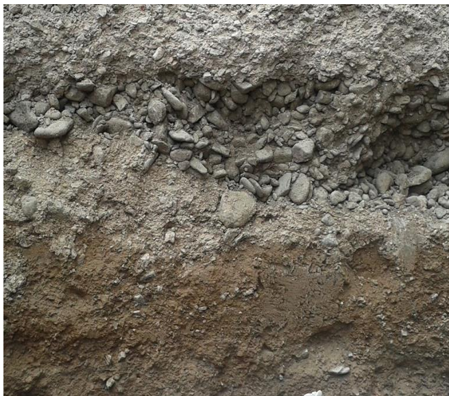
Figura No.7. Perfil de suelo en la una de las zapatas de la construcción del edificio del poder judicial de Chihuahua, en dicho perfil se puede apreciar claramente que el estrato es rocoso y se ve de igualmanera la posición del nivel freático. (Fuente Propia).
