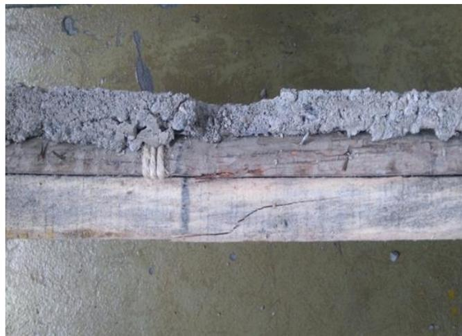
Figura 19. Falla por Cizallamiento o corte
