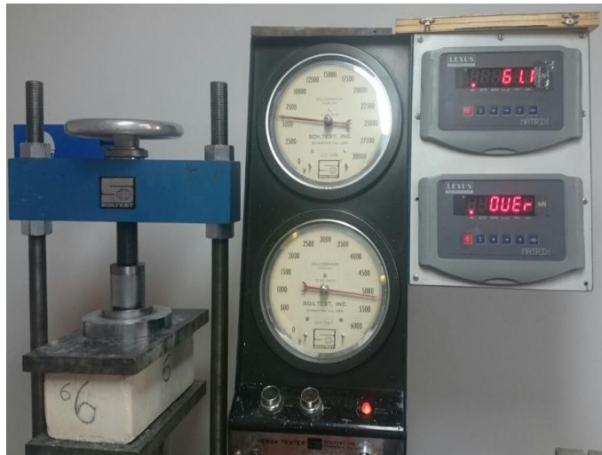
Imagen 21 . Prueba de resistencia a la compresión. Fuente: Elaboración Nicolás Garzón y Cesar Triana.
