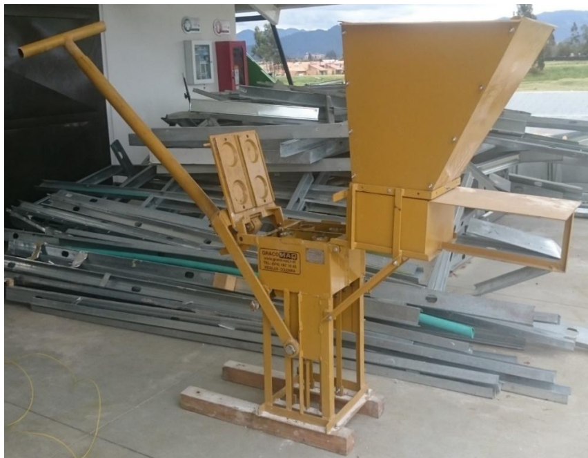
Imagen 2 . Prensa manual Cinva-Ram utilizada para la elaboración de BTC. Fuente: Elaborado por Nicolás Garzón y Cesar Triana.
