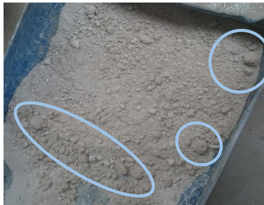
Imagen 22 . Condensaciones de material al adicionar agua a la mezcla. Fuente: Elaboración Nicolás Garzón y Cesar Triana.
