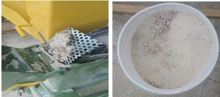
Imagen 14. Celulosa retirada parcialmente alojada en la criba del molino y polvo de yeso recuperado. Fuente: Elaboración Nicolás Garzón y Cesar Triana.
