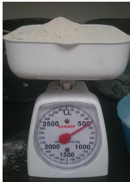
Imagen 17. Pesaje de cada uno de los materiales antes de adicionar a la mezcla.
