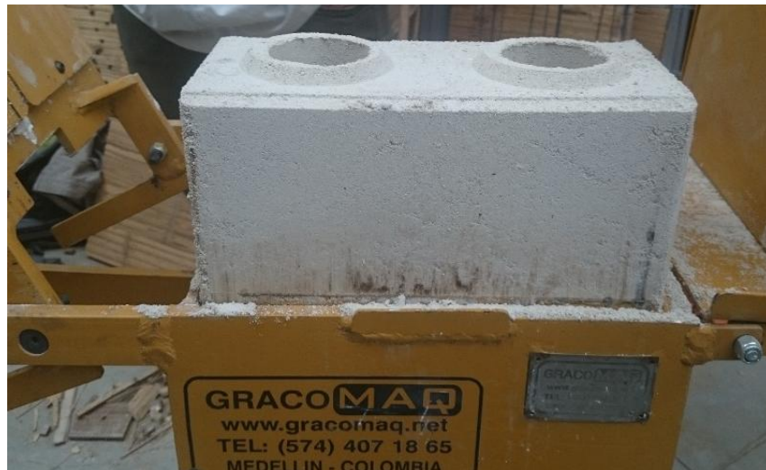
Imagen 20. Obtención del prototipo del bloque compactado. Fuente: Elaboración Nicolás Garzón y Cesar Triana.
