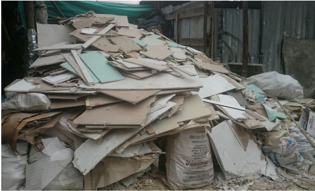
Imagen 5 . Residuos de construcción, Placas de yeso laminado. Fuente: Elaboración Nicolás Garzón y Cesar Triana.
