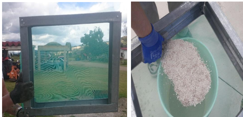
Imagen 15. Malla de polietileno tipo mosquitero y separación de la celulosa. Fuente: Elaboración Nicolás Garzón y Cesar Triana.
