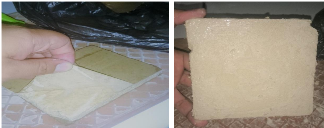
Imagen 12. Separación de la celulosa de los residuos recuperados. Fuente: Elaboración Nicolás Garzón y Cesar Triana.
