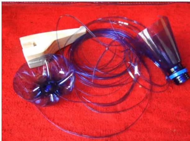
Figura44: fibra obtenida del reciclaje de la botella o plástico PET
