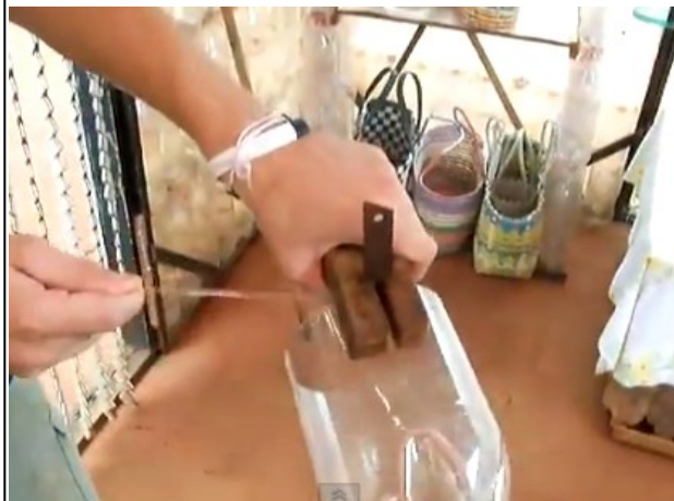
Figura 46: Herramienta de corte de las botellas o plástico PET
