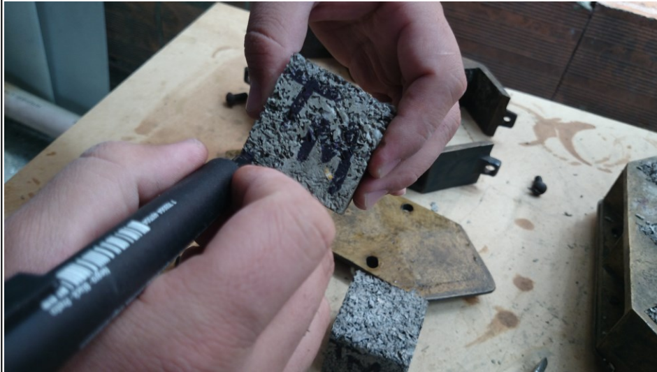
Figura 51: Muestras elaboradas para fallo en laboratorio
