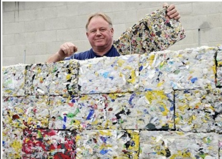
Figura 24: Bloques prensados con plástico compactado
