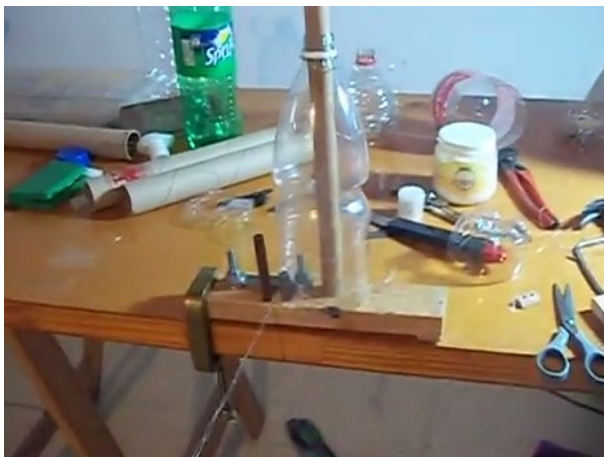
Figura 43: proceso para obtención de fibras al reciclar las botellas
