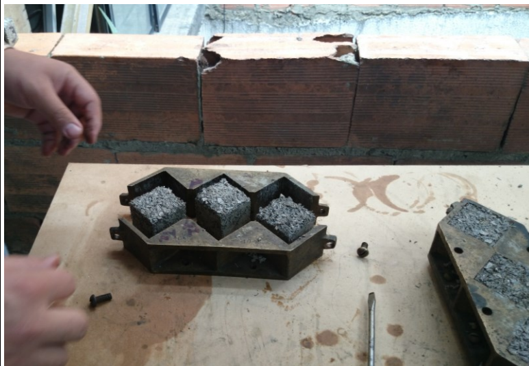
Figura 60: Desmolde de cubos para fallos en el laboratorio
