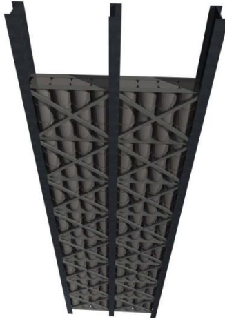
Grafico N° 74: sistema de union entre modulos para muro
