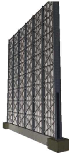
Grafico N° 59: Cimentacion y muro en alumplac
