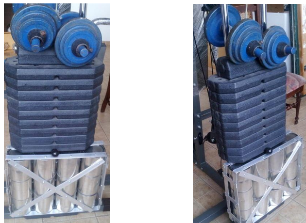
Grafico N° 42: Modulo de muro sometido a peso total
