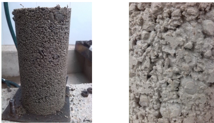
Figura 80. Mezcla de PET al 20% muestra como es la porosidad del elemento.
