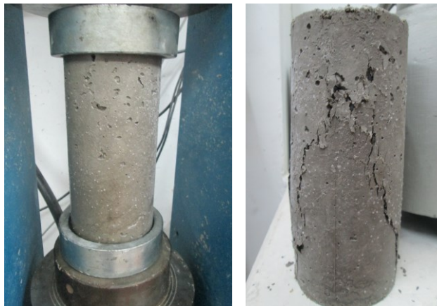
Figura 86. Prueba compresión PET al 5%
