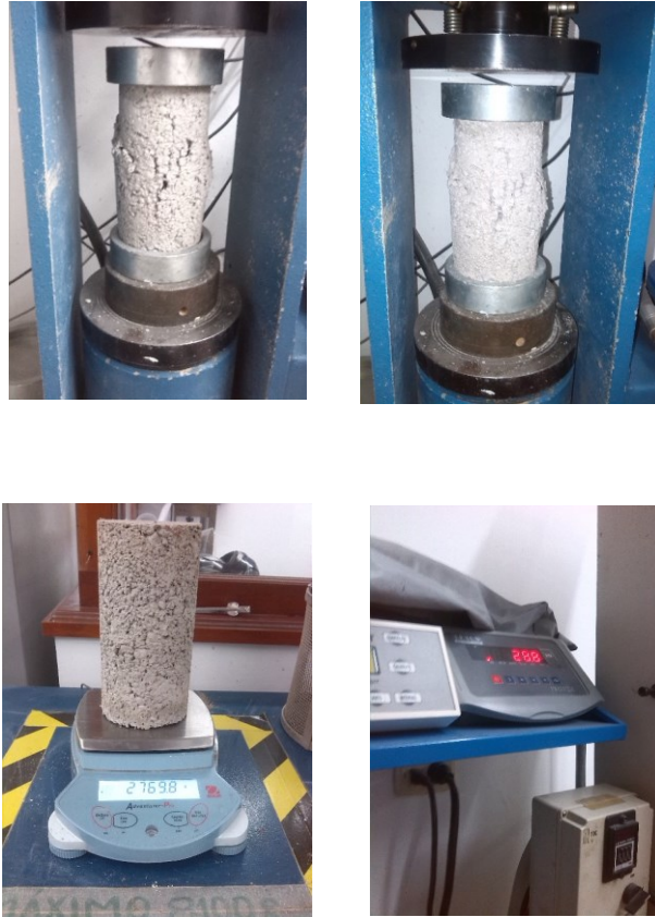
Figura 81. Prueba compresión con PET al 20%
