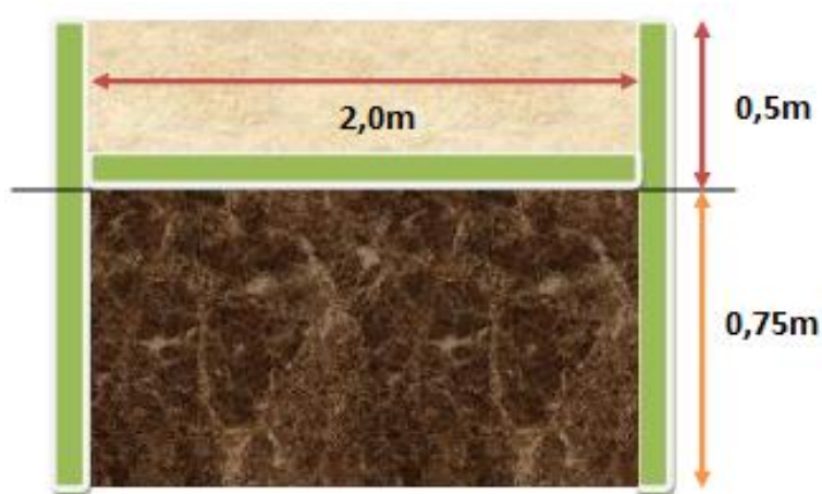
Figura 33. Diseño de Trinchos de Guadua para el Talud N°3 y N°4 Fuente: Propia
