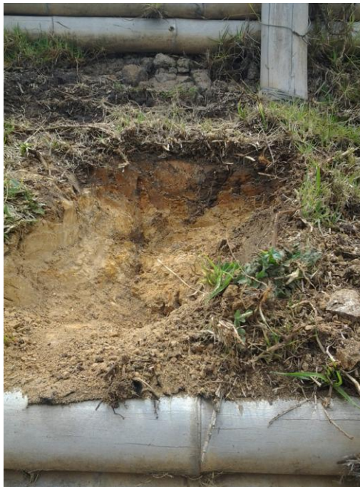
Fotografía 16. Trinchera superficial para la extracción de bloques de material Fuente: Propia
