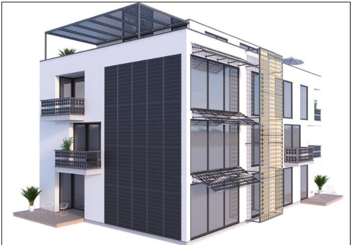
Figura 15: Fachada con panel de vidrio fotovoltaico
