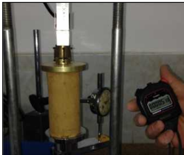
Fotografía 14. Montaje de la muestra en el equipo para la compresión inconfiada. Se observa el montaje de la muestra para el ensayo, es necesaria la medición del tiempo con ayuda del cronometro y medición de la deformación como se muestra en la fotografía.
