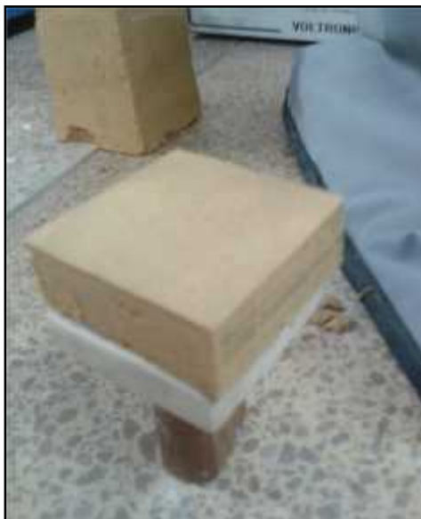
Fotografía 15. Moldeamiento de las muestras para ensayo de corte directo, con molde y equipo de moldeamiento.
