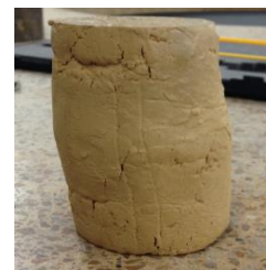
Muestra 3 después de la falla
