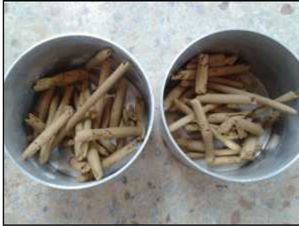
Fotografía 4. Rollitos de caolín en estado plástico. Para estos se realizaron con diámetro de 3.00mm, según la norma.
