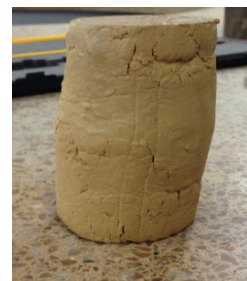
Muestra 2 despues de la falla
