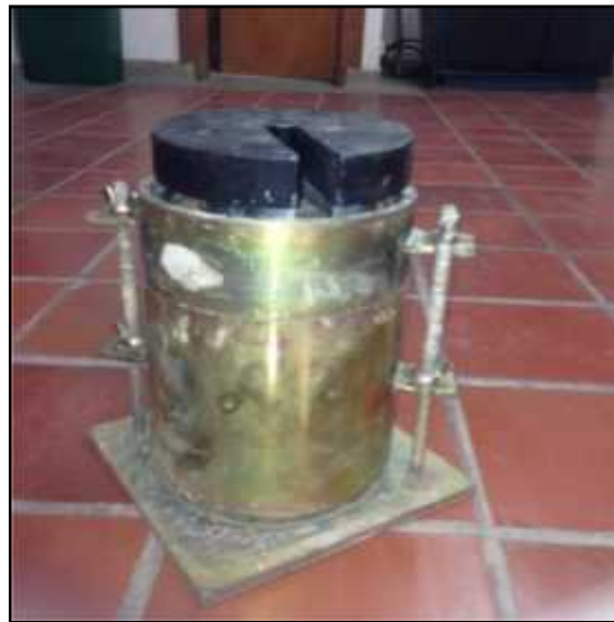
Fotografía 8. Compactación del espécimen en molde CBR con discos de carga. La carga aplicada es de 80 Kg para que éste no se asentara rápidamente.
