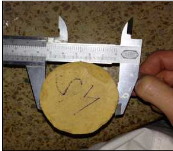
Fotografía 13. Diámetro de la Muestra 2. Se observa el diámetro para el ensayo de compresión inconfiada.
