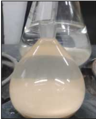
Fotografía 5. Picnómetro con agua y caolín a 20°C de temperatura. En la fotografía se observa el proceso necesario para la disipación de vacíos del caolín con agua dentro del picnómetro.
