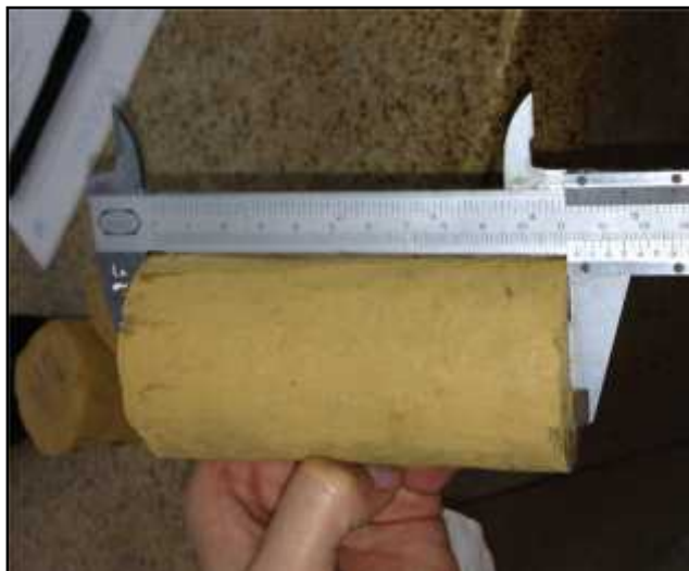
Fotografía 12. Altura de la muestra 2. Se observa a que altura quedo la muestra para el ensayo de compresión inconfínada.
