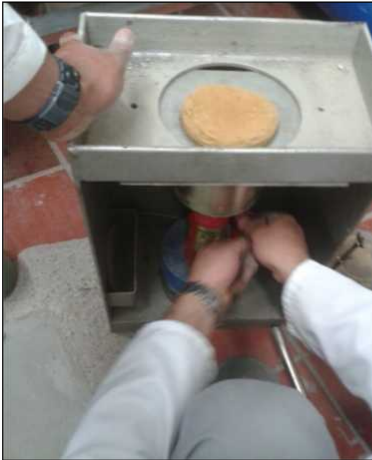
Fotografía 11. Extracción del espécimen con gato hidráulico y disco de igual área a la del molde. Se realizó lentamente para no alterar los vacíos que pudieran existir alrededor de las paredes.
