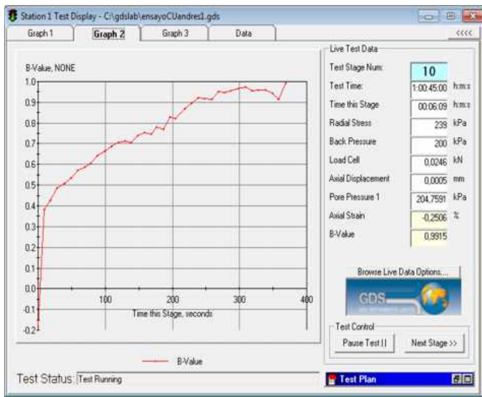
Fotografía 21. Chequeo del parámetro B de Skempton.
