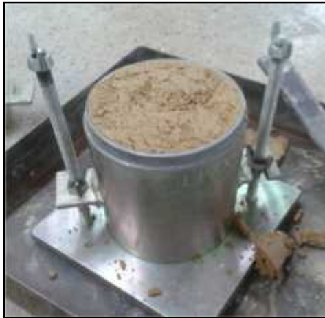
Fotografía 6. Compactación del caolín. En la fotografía se observa el caolín compactado a 25 golpes y a ras del molde sin anillo. Se observa material suelto debido al enrazado.
