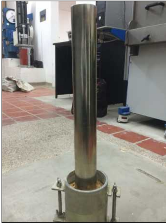
Fotografía 10. Extracción de la muestra con tubo shelby del ensayo de compactación normal. Se centra el tubo en la muestra y se hinca despacio para no generar demasiada alteración en la muestra extraída.
