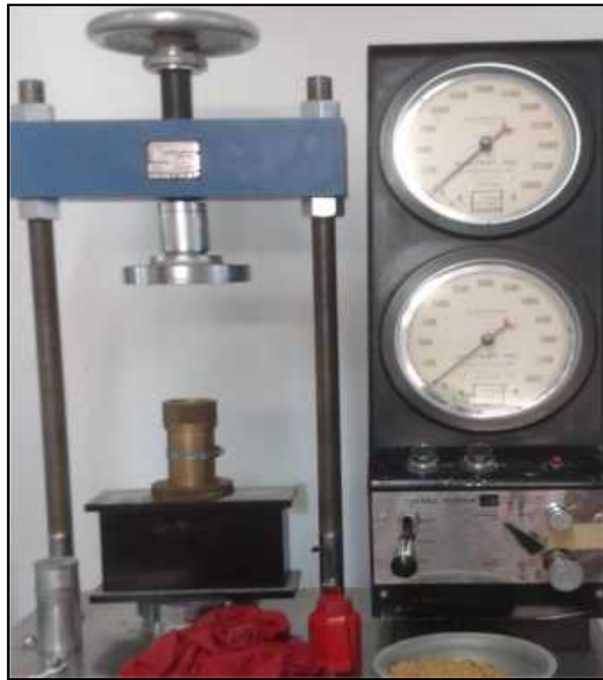
Fotografía 9. Montaje para compactación de la muestra en molde de 2" con Máquina Versa Tester. Se centra el molde y se compacta con un apisonador de las mismas dimensiones del molde.
