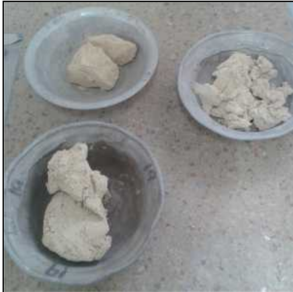
Fotografía 7. Muestras de caolín secas. En la fotografía se observa las muestras de caolín secas con diferentes humedades para determinar las densidades secas para la caracterización del caolín.
