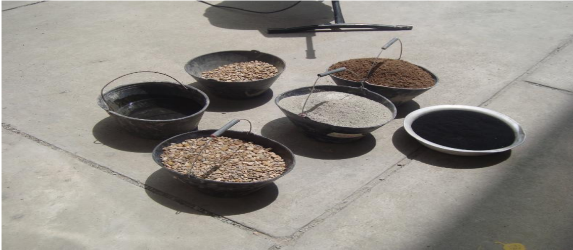
Fotografía No. 6. Dosificación de mezcla con reemplazo de arena por caucho
