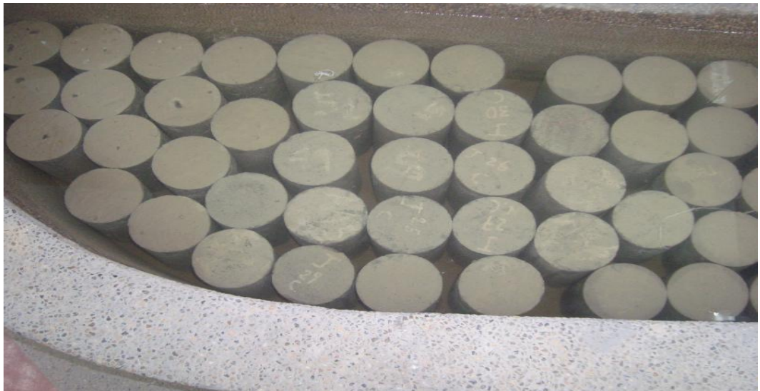
Fotografía No. 4. Curado de concreto en inmersión.
