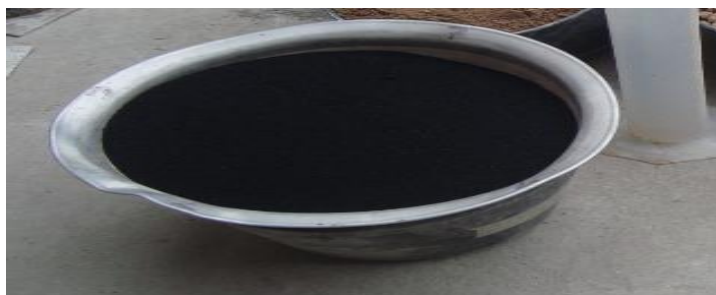
Foto No. 7. Agregado fino neumático.
