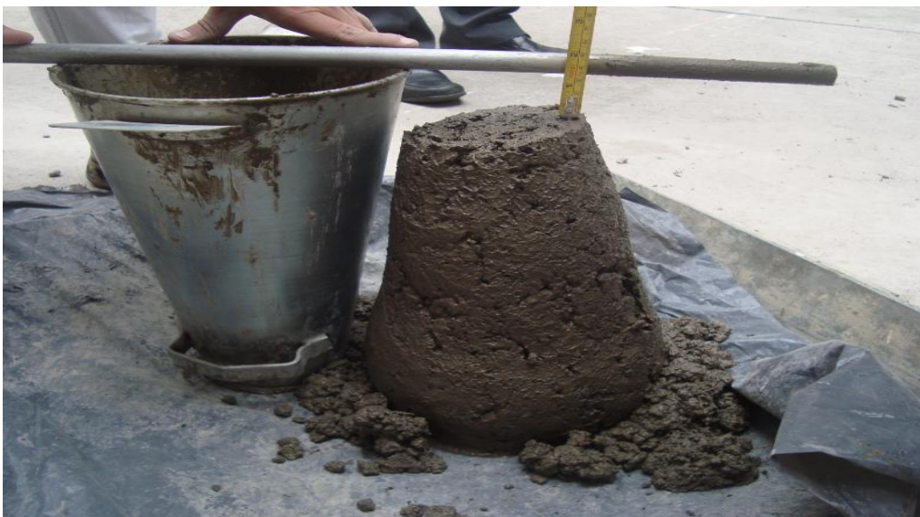
Fotografía No. 8 Determinación de asentamiento
